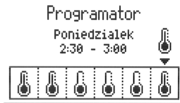
Ilustracja 21: Ekran programator kotła
