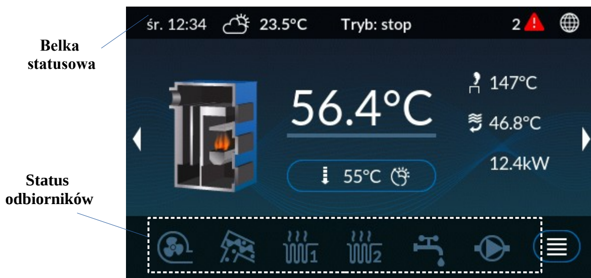
Ilustracja 14: Ekran główny, ekran kotła C.O.
