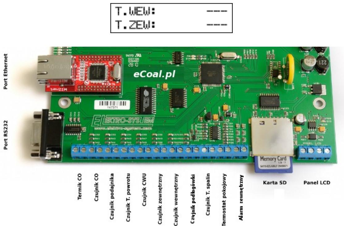
Иллюстрация 3: Зажимная планка для подключения датчиков
