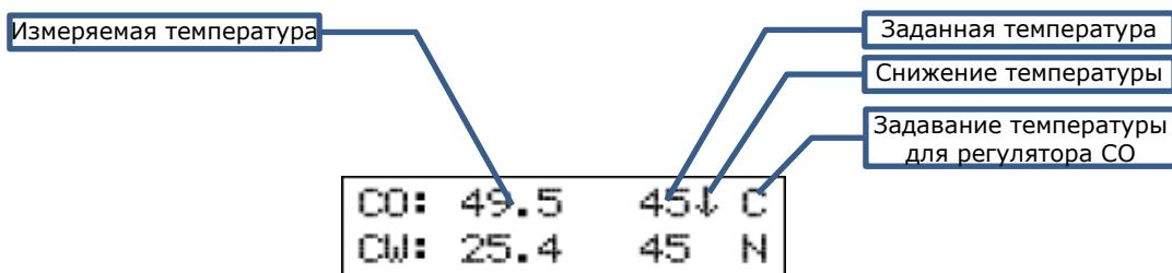
На главном экране имеется также информация о работе котла с пониженной температурой. Информация появляется при посредстве стрелки, направленной вниз, которая находится при заданной температуре ЦО и ТХВ. Отсутствие стрелки обозначает нормальную температуру.
