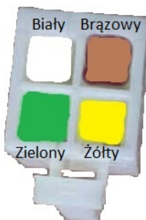
Ilustracja 1: Podłączenie panelu szklanego
