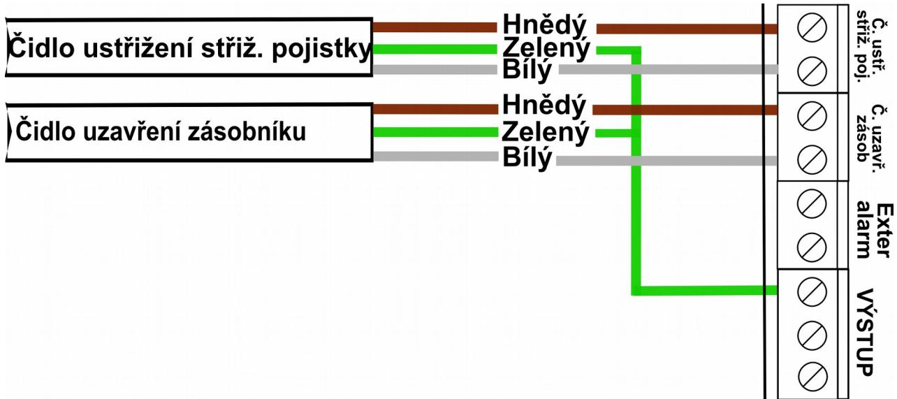
Obrázek 4: Připojení čidel: střížení pojistky podavače (závlačky) a uzavření zásobníku
