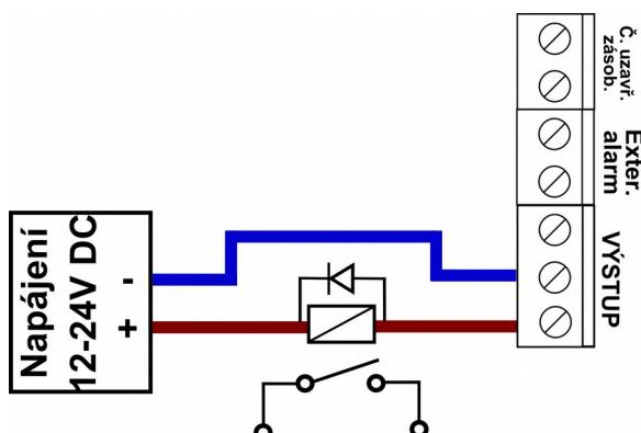
Obrázek 14: Připojení přídavného alarmu na výstup alarmu
