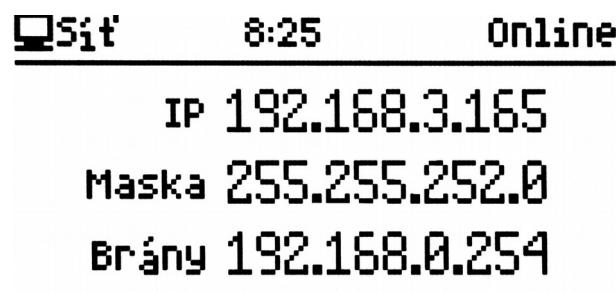
Obrázek 12: Obrazovka síťového nastavení
