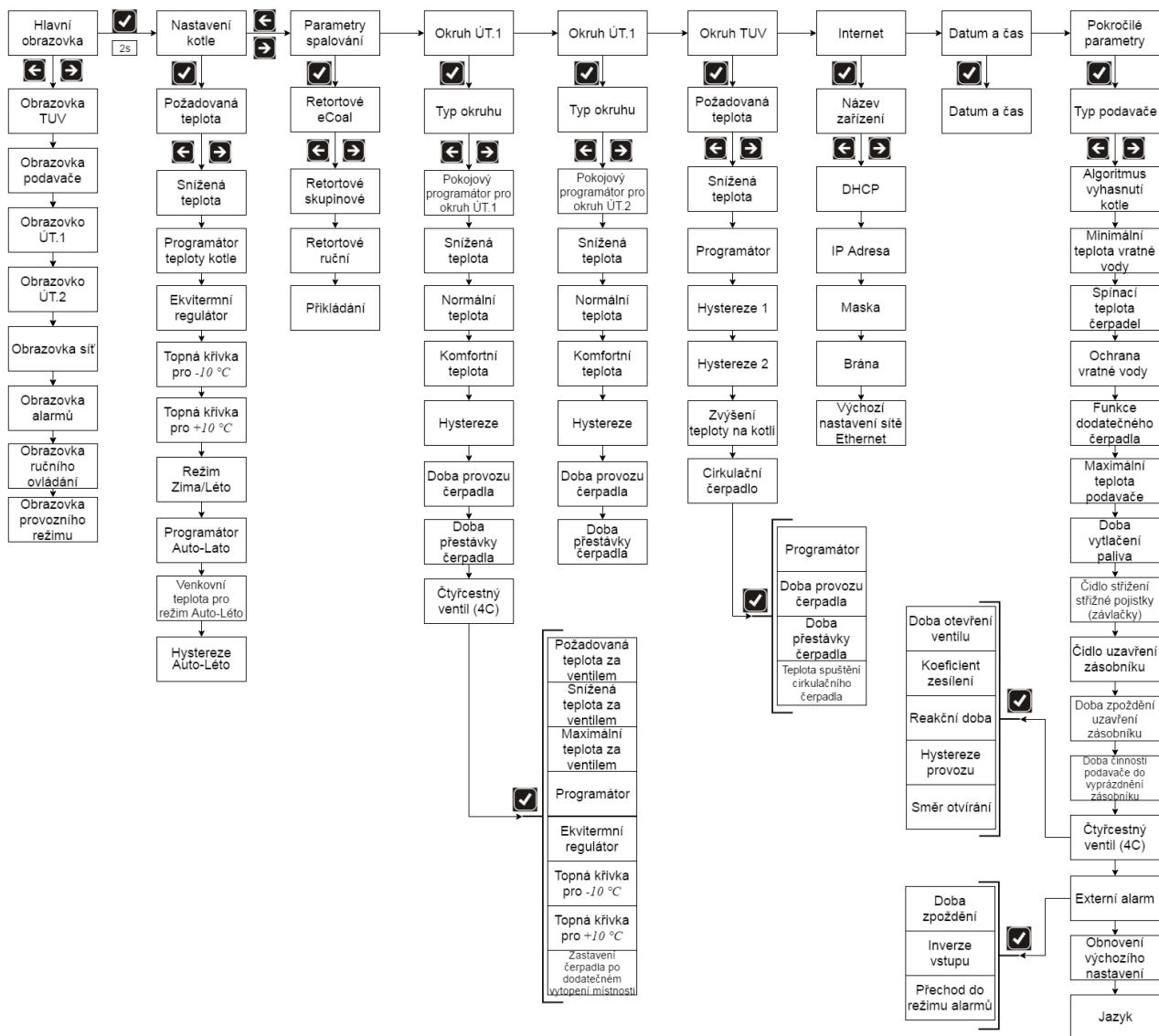
Obrázek 17: Schéma menu řídicí jednotky
