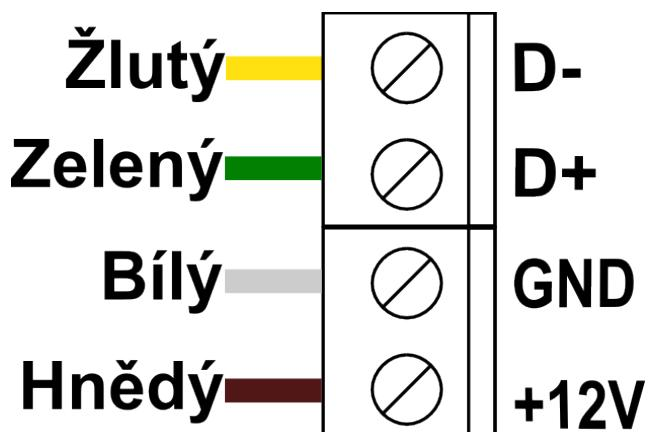
Obrázek 1: Zapojení panelu Standard
