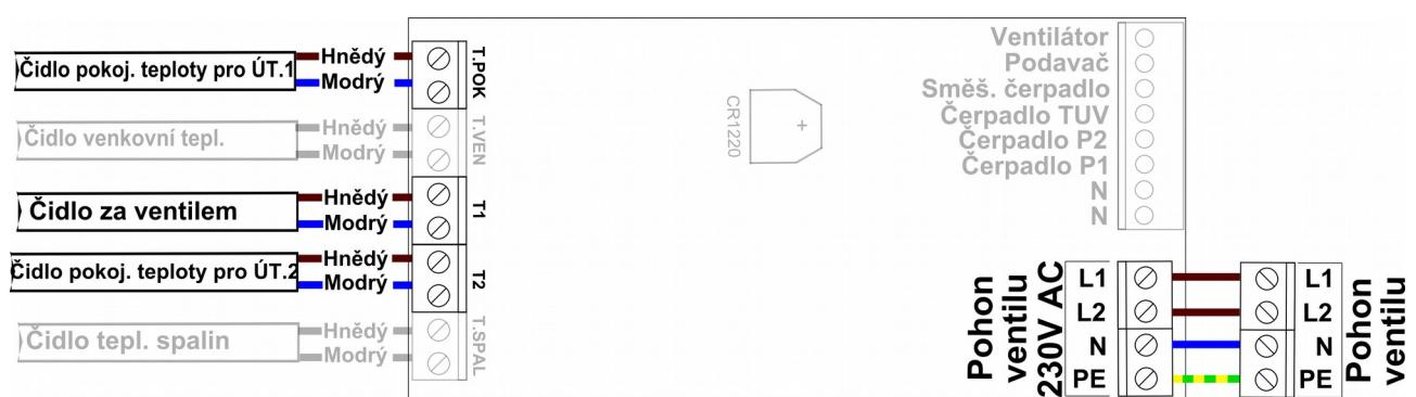
Obrázek 16: Zapojení pohonu ventilu a pokojových čidel pro okruh ÚT.1.
