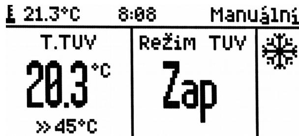
Obrázek 7: Obrazovka obsluhy TUV
