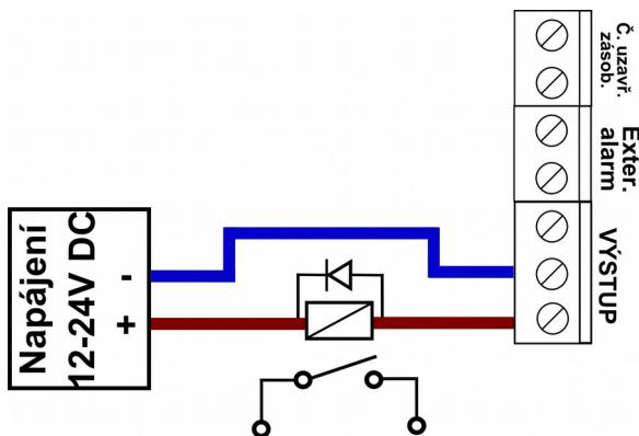
Obrázek 15: Připojení přídavného alarmu na výstup alarmu
