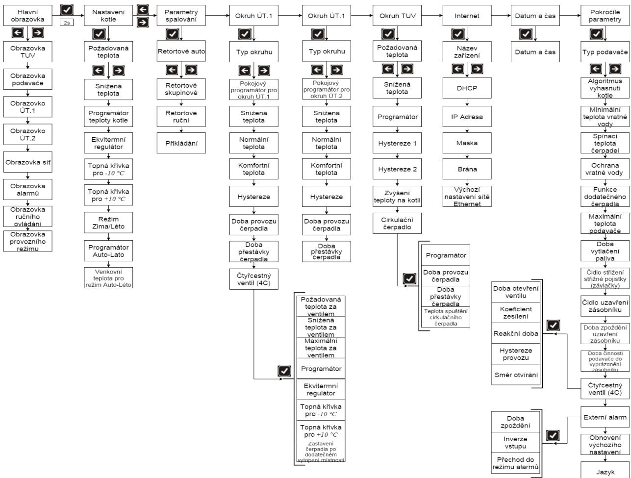
Obrázek 18: Schéma menu řídící jednotky
